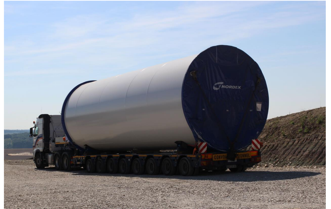
Transport d'une section de mât d'éolienne (Source : Ora environnement)
